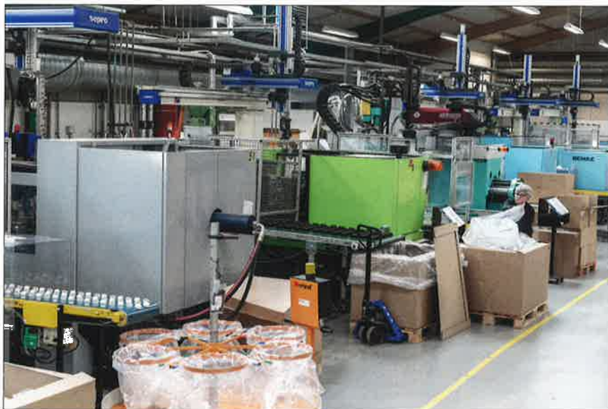
Produktionsceller med robotstyring kører fuldautomatisk og uden bemanding i flere timer ad gangen.
